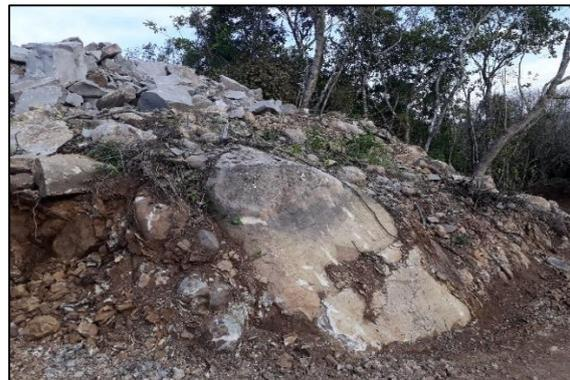
Figura 16: Corte do terreno mostrando a pequena espessura do solo e o embasamento rochoso.
