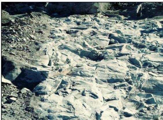
Figura 05: Local onde ocorreu o desmonte da rocha mostrando a rocha basáltica sã.
